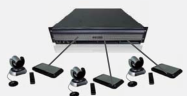
MCU（専用サーバ）と子機の形態 拠点数が多くなるとこの形態
