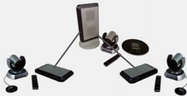
親機端末と子機端末の形態 数拠点環境を安く構築できる形態
