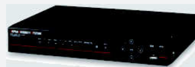
▲AHD 4ch デジタルレコーダー ※ AHD 規格だけでなく アナログカメラにも対応
