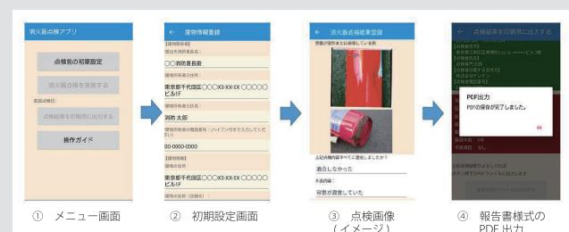
写真等を用いた案内により、消防法令に規定する点検項目の基準に適合しているかどうかを選択するとともに、その点検結果を消防法令に定められた報告書の様式に反映しPDFファイルとして出力することができます。
